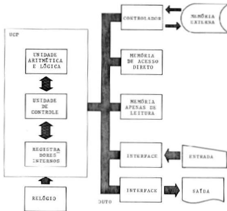
Figura 2 — Aspectos da arquitetura geral de um microcomputador
